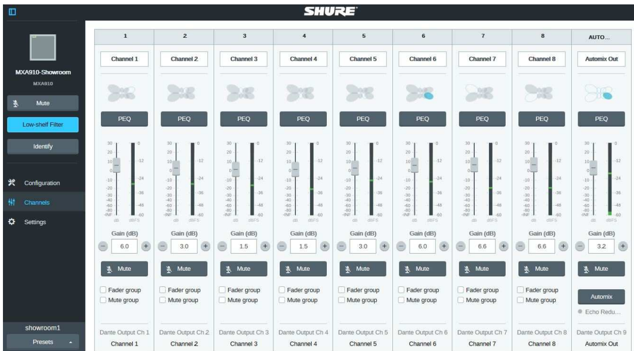
Onglet Channels - Permet l'accès aux presets, au gain, Eq, Mute, Groupe de Fader et de Mute, et Automix
